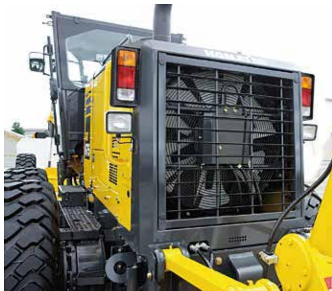
Ventilador hidráulico de enfriamiento
