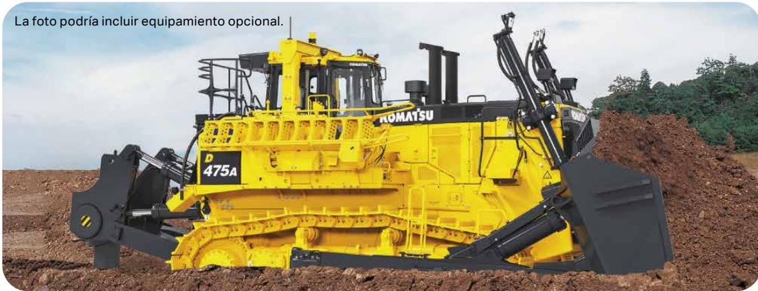
La hoja superdozer es adecuada para condiciones o aplicaciones particulares, como recuperación, nivelación o movimiento de material suelto, mientras que la hoja semi U es adecuada para excavación de materiales duros o rocosos o aplicaciones de corte lateral. Consulte a su distribuidor sobre las especificaciones adecuadas para su aplicación.
